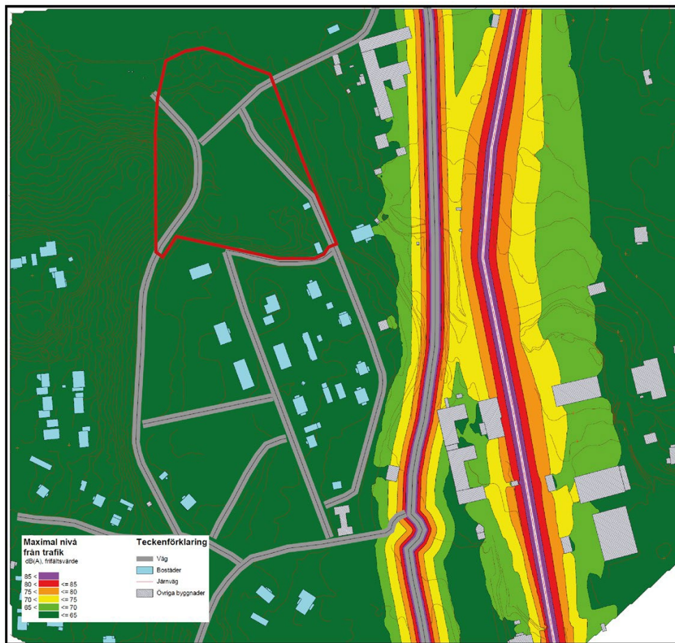
Illustration som visar maximal bullerberäkning för trafik gjord av Ramböll. Planområdet markerat i rött.
